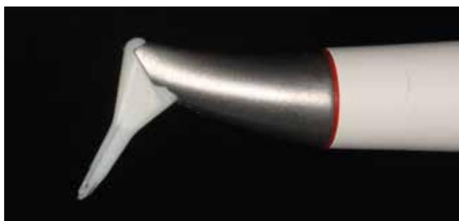
**Fig. 1 :** Embout à usage unique Perio-Flow® avec trois orifices de sortie horizontaux destinés au mélange air-poudre et un orifice de sortie vertical pour l'eau.
